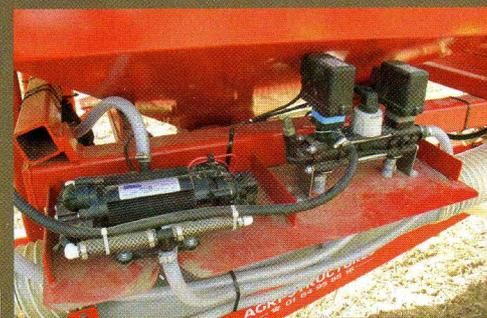
▲ **ÉLECTRONIQUE** Le système de pulvérisation fait appel à une régulation de type DPAA.
