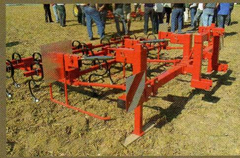
▲ **GUIDAGE** Le dispositif de guidage des bineuses d'Agri-Structures repose sur un ski qui suit une empreinte préalablement tracée.
